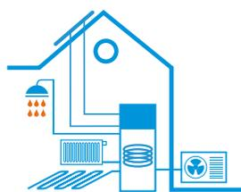
Die DAIKIN Altherma 3 R ECH<sub>2</sub>O kombiniert auf kleinstem Raum hocheffiziente Wärmepumpentechnik mit einem innovativen Wärmespeicher. Auf nur 0,36 m<sup>2</sup> (Version 300
