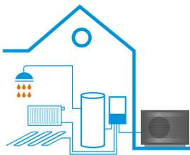
Der modulare Aufbau der DAIKIN Altherma 3 H HT W ermöglicht vielfältige Anwendungen. So lassen sich die kompakten Innengeräte einfach zu Kaskaden für Mehrfamilienhäuser kombinieren.
