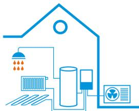
Der modulare Aufbau der DAIKIN Altherma 3 R W ermöglicht vielfältige Anwendungen. So lassen sich die kompakten Innengeräte einfach zu Kaskaden für Mehrfamilienhäuser kombinieren.
